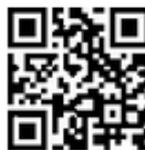
QRコードモデル2は、コードが大きいときの歪みに対する耐量を向上させるため、アライメントパターンを追加した構造となっています。モデル2は、バージョン\*1から40までをAIMI規格としています。バージョン40には、数字だけなら最大7089文字もコード化することができます。
