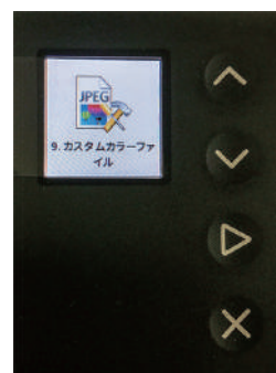
▲ スキャナー本体のカラーディスプレイの表示を確認しながら、スキャン条件を選択してスキャンの実行
